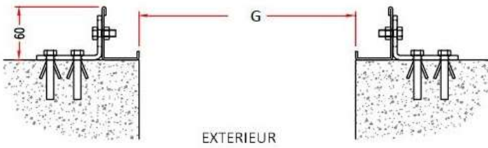
MISE EN PLACE DU PRECADRE AVEC KIT PATTES
